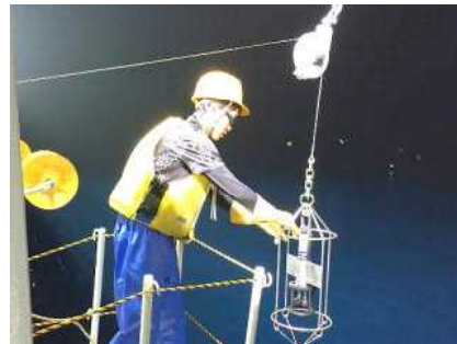
操業開始時に、海水の温度等のデータを測定する海洋観測作業。水深 450 mまで測定します
