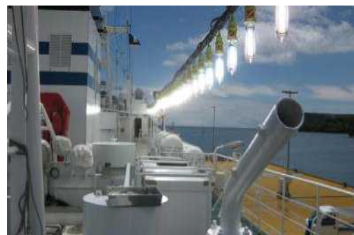
イカ釣り用集魚灯点灯試験 （130個の集魚灯点灯）
