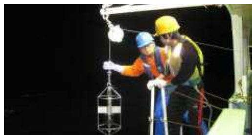
操業地点のデーター採取 (計測器投入) (水深 500 m までの水温・塩分濃度測定)
